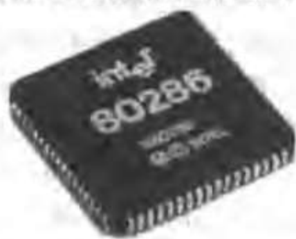
图 3.1.6 PQFP 封装 80286 的 CPU
