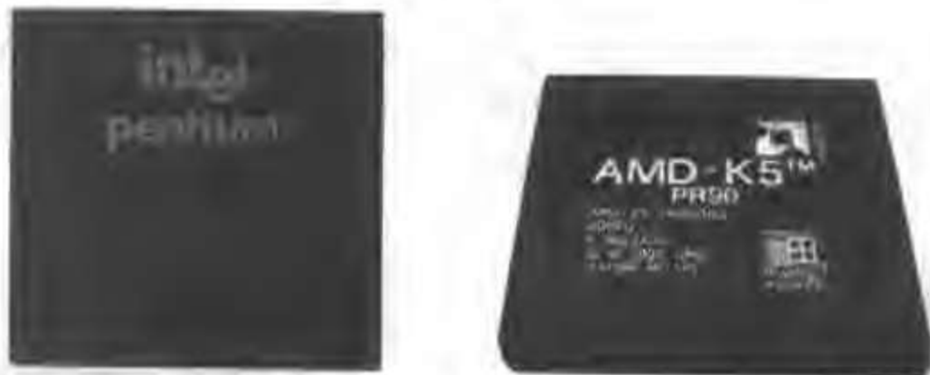
图 3.1.7 SPGA 封装的 Pentium 和 AMD K5 CPU
