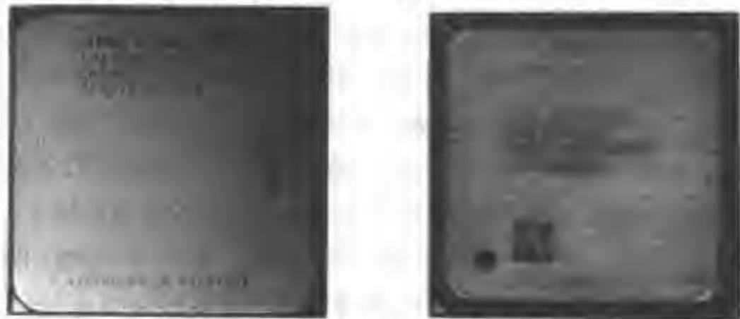
图 3.1.10 FC-PGA2 封装的 Athlon 64 和 P4 CPU
