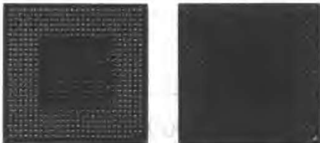
图 3.1.2 CPU 背面的金属引脚
