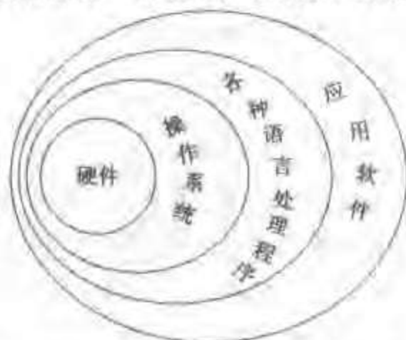
图 1.2.3 硬件系统和软件系统之间的关系
