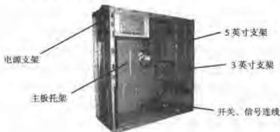
图 7.1.3 机箱的内部结构
