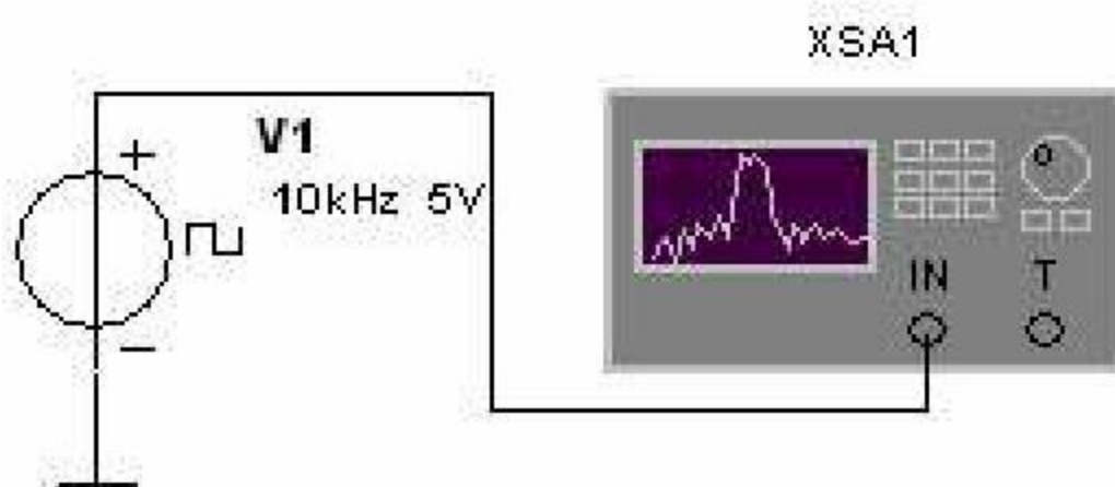
图 3-65 方波频谱分析电路图
