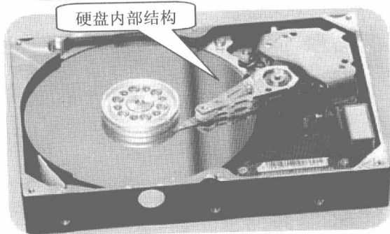
图 8-36 硬盘内部结构
