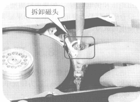
图 8-39 拆解磁头
