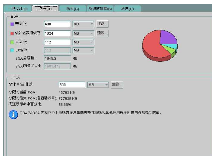
图 4-2 Oracle 9i SGA 各部分参数设置
