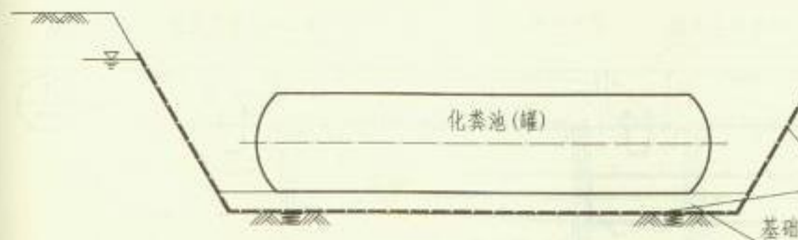
基坑土工布铺设纵断面图
