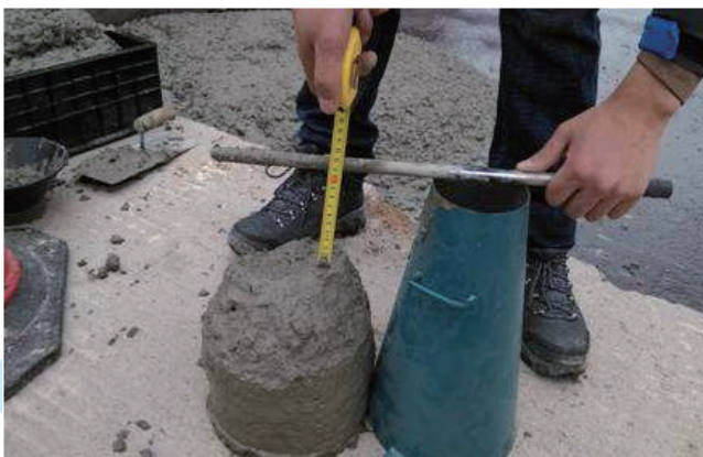
图 14-7 坍落度检测
