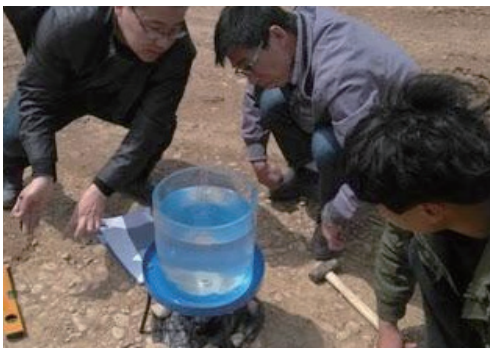
灌水法检测压实度
