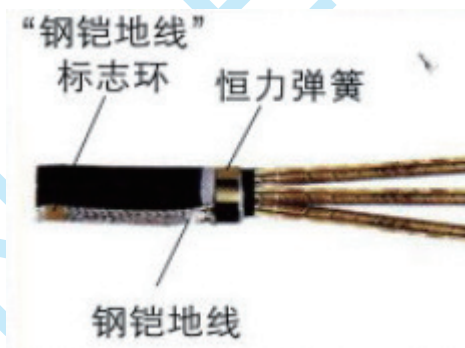
图 21-49 钢甲接地线连接
