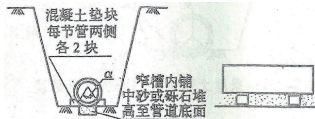
图 23-11 采用四点支承法的排水管道铺设
