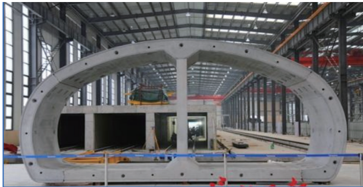
图 11.4.1 预制拼装结构
