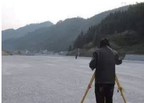
沉降法检测压实度
