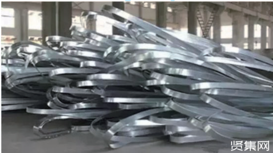
图 21-56 防雷接地扁铁材料
