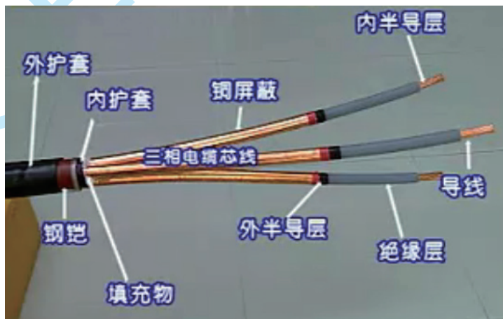
图 21-43 高压电缆结构
