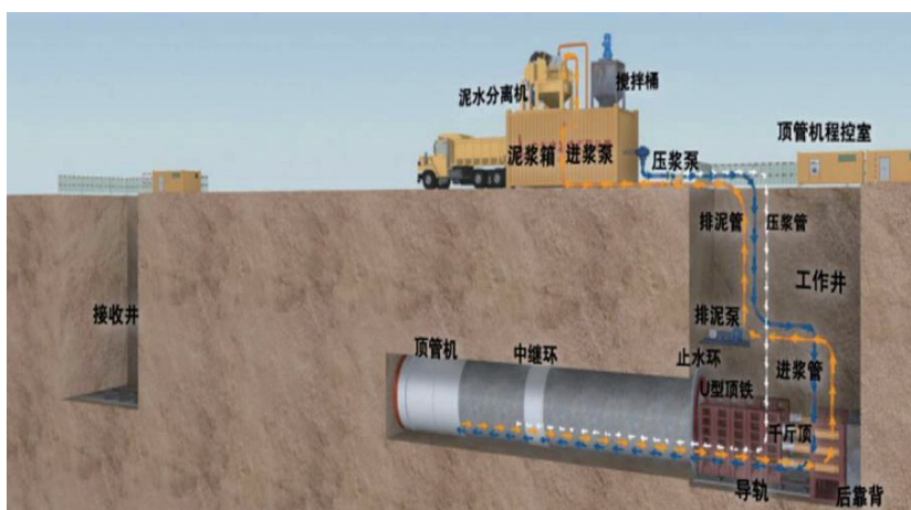
顶管施工示意图
